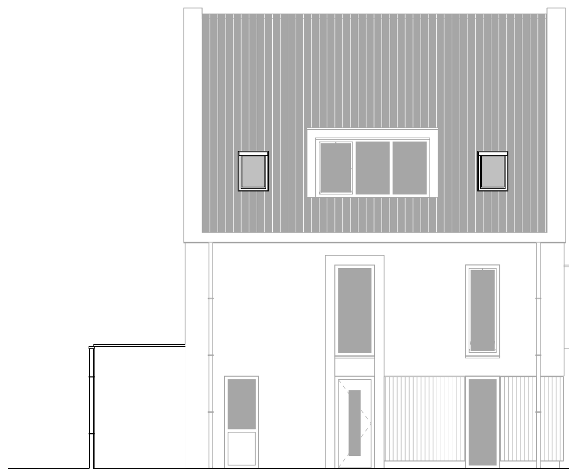
Zijgevel links uitbouw 2400mm. dakvenster. sparing dakvenster.
