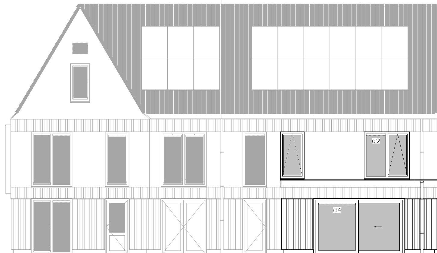
Achtergevel uitbouw 1200mm. schuifpui.
