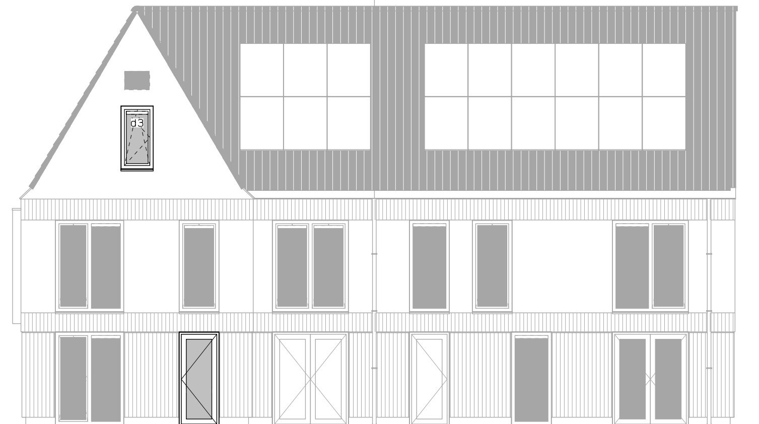
Achtergevel deur lage borstwering.
