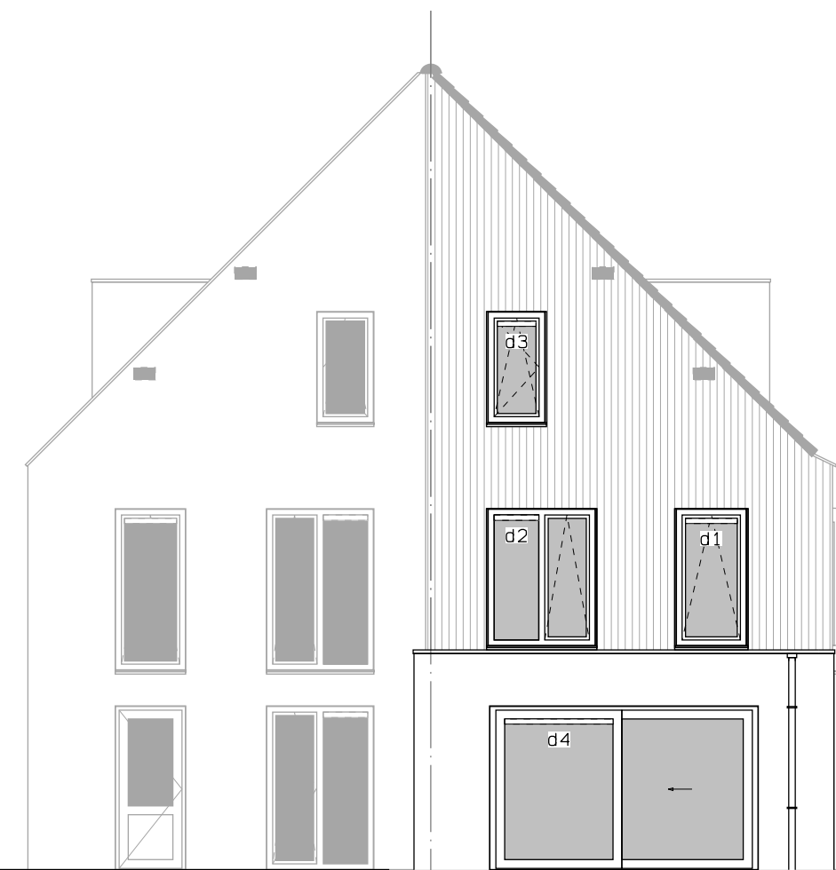
Achtergevel uitbouw 1200mm. schuifpui.
