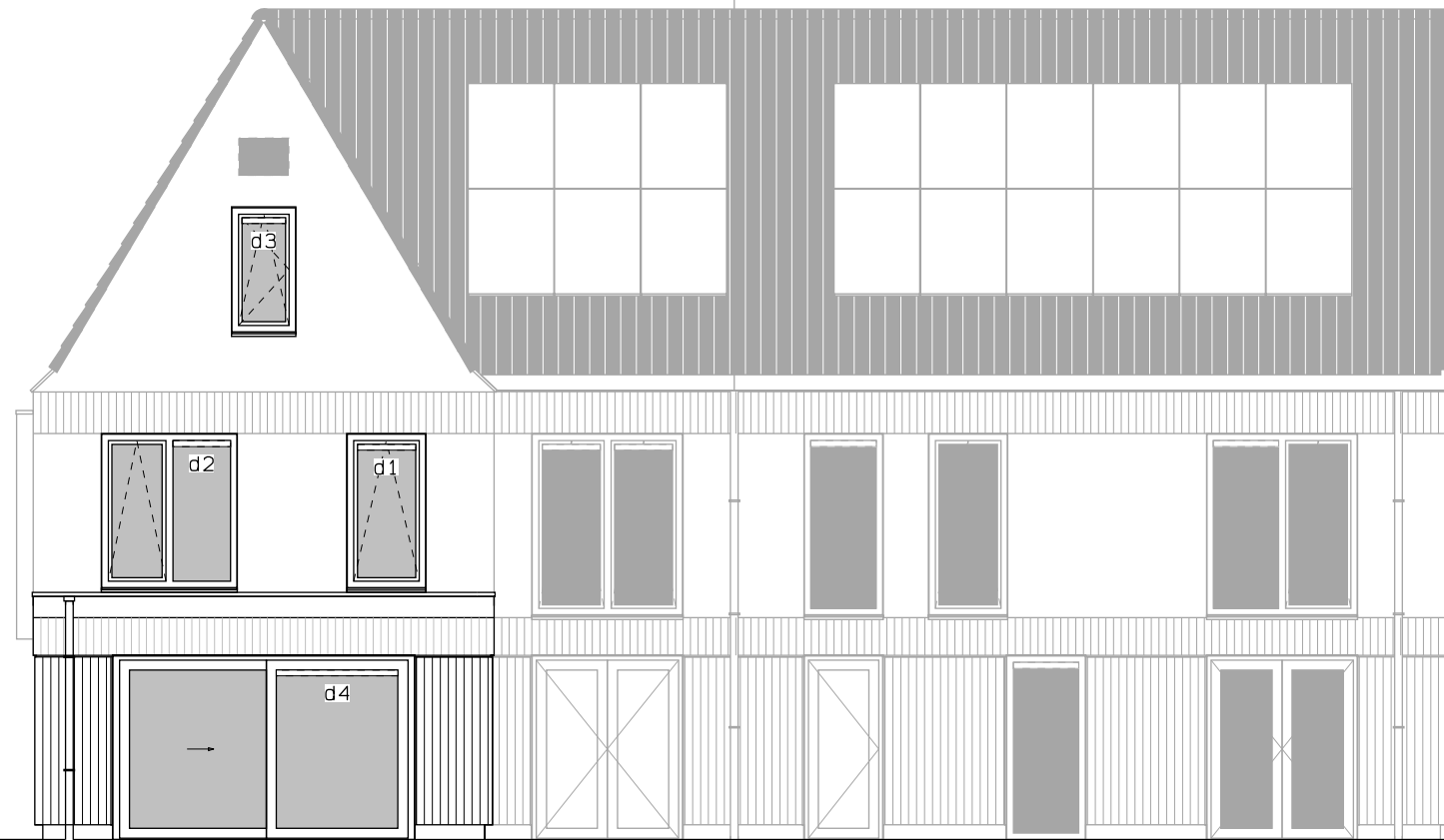
Achtergevel uitbouw 1200mm. schuifpui.
