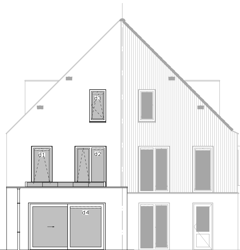
Achtergevel uitbouw 1200mm. schuifpui.
