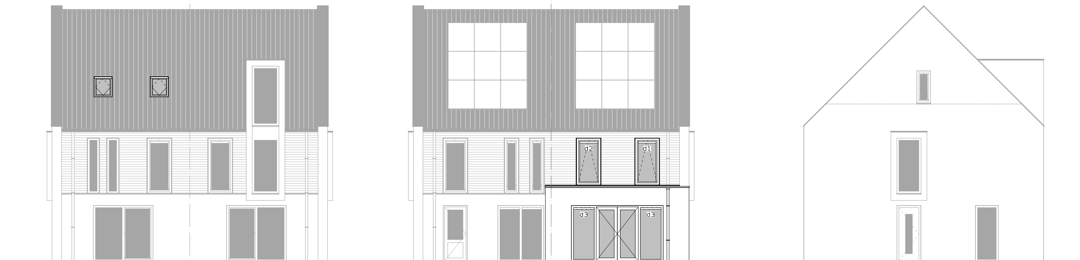
Voorgevel dakvenster. sparing dakvenster.
