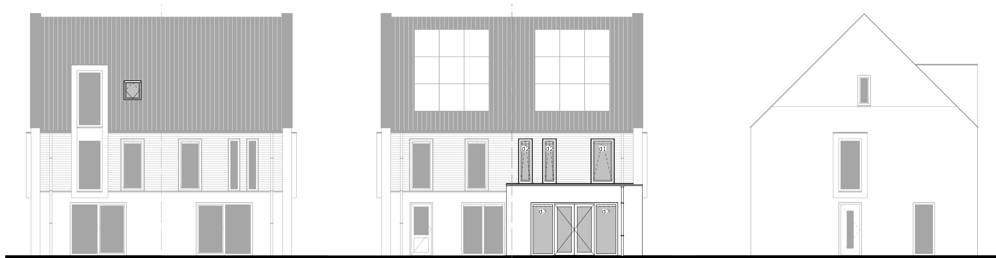
Voorgevel dakvenster. sparing dakvenster.
