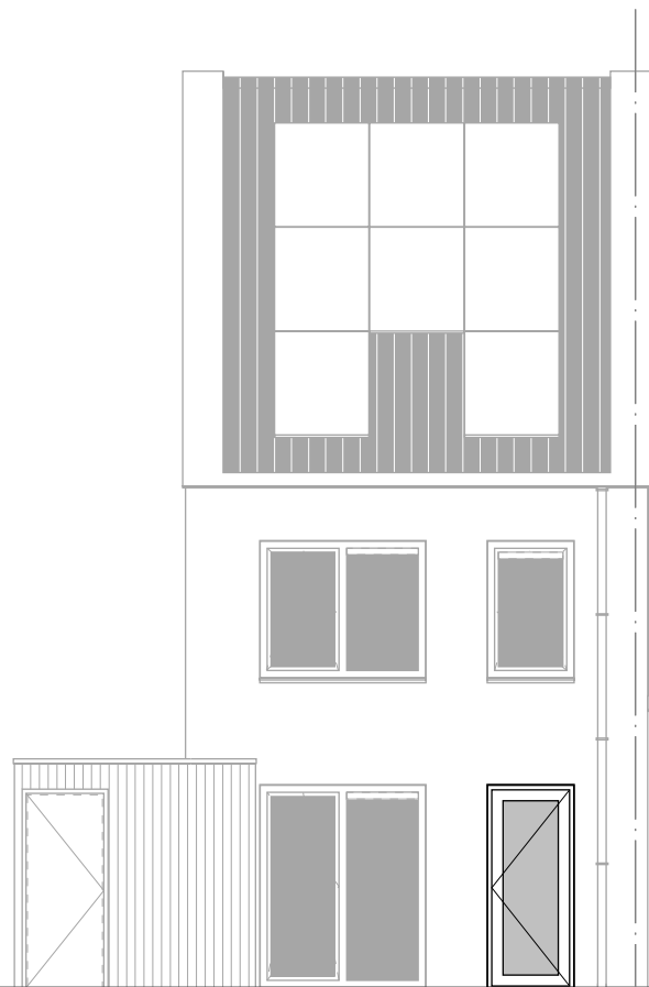
Achtergevel deur lage borstwering.
